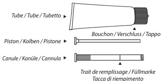
**1** A la première utilisation, retirez le bouchon du tube, retournez-le et utilisez la pointe acérée pour percer l'extrémité du col du tube.
